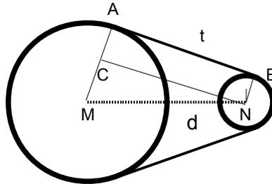
Da Tangenten an einen Kreis stets senkrecht auf dem zum Berührungspunkt eingezeichneten Radius stehen, sind  $BN$  und  $AM$  parallel. Verschiebt man dann das Tangentenstück  $AB$  parallel entlang  $BN$  und  $AM$  um die Strecke  $r$  (also bis  $B$  auf  $N$  zu liegen kommt), so ergibt sich das rechtwinkelige Dreieck  $MNC$  mit den Seitenlängen  $R-r$ ,  $d$  und  $t$ . Pythagoras liefert:
